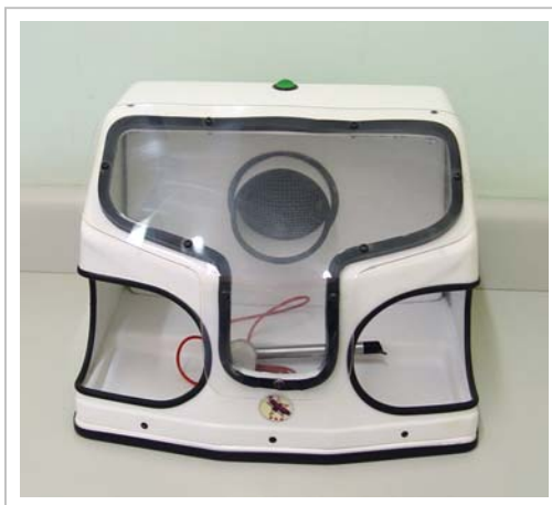
Figura 8 - Caixa apropriada para realização do jateamento com possibilidade de visualização, munida de exaustor
