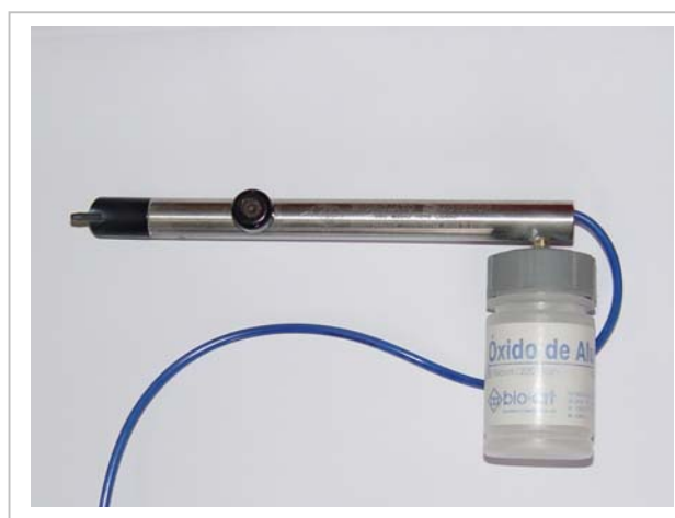
Figura 5 - Micro-jato Bio-art e óxido de alumínio (50 micrômetros)
