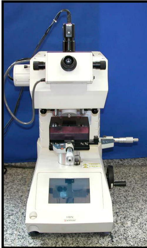
Figura 4 – Microdurômetro (HMV-2000)
