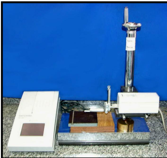
Figura 5 – Rugosímetro Surf Corder.
