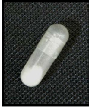
Figura 9 – Cápsula contendo o pó do compósito Filtek Z250 triturado.
