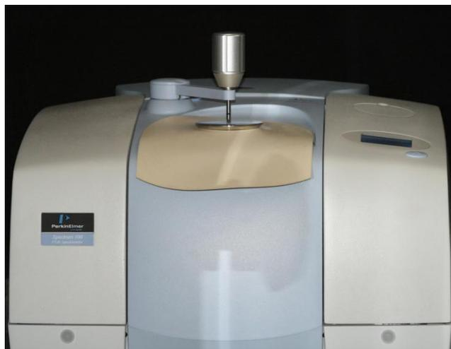
Figura 4.5.1- Spectrum 100 Optica; PerkinElmer - espectrômetro de raios infra-vermelhos transformado de Fourier.
