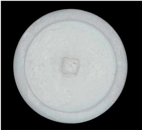
Figura 15: Porta amostra de teflon com depressão central quadrada (4x4x1 mm).
