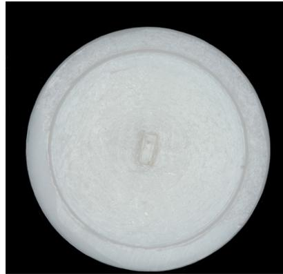
Figura 36: Porta amostra de teflon com cavidade central de 2x4 mm e 4 mm de espessura.
