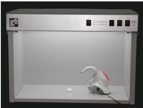
Figura 17: Caixa de iluminação Gti Minimatcher utilizada nas leituras de cor.
