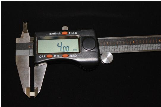
Figura 13: Aferição da altura e largura dos blocos em 4x4 mm.
