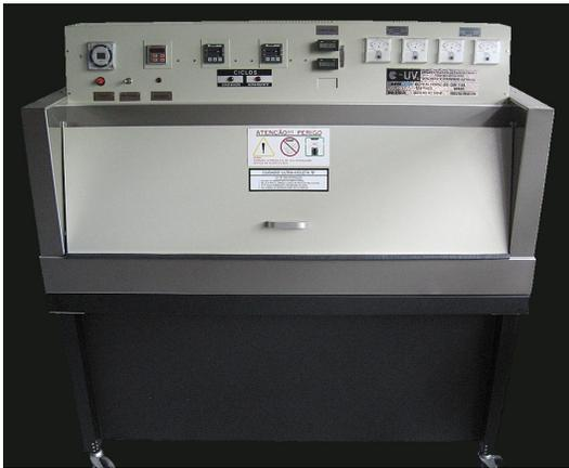
Figura 37: Máquina de envelhecimento acelerado Equilam.
