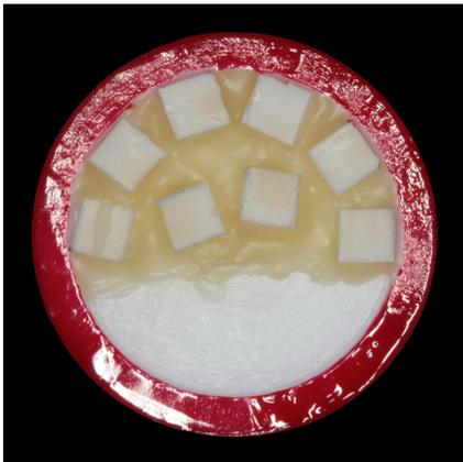
Figura 11: Batente da matriz de teflon pintado com verniz para evitar o desgaste do mesmo e os blocos de dentina posicionados.
