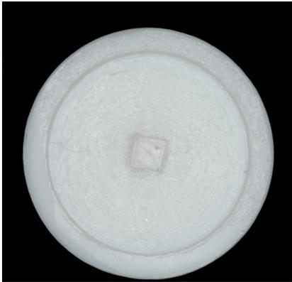
Figura 35: Porta amostra de teflon com cavidade central de 4x4 mm e 2 mm de espessura.
