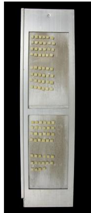
Figura 38: Amostras fixadas com cola a base de silicone para exposição ao envelhecimento acelerado.
