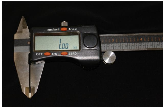
Figura 12: Aferição da espessura dos blocos em 1 mm de espessura.
