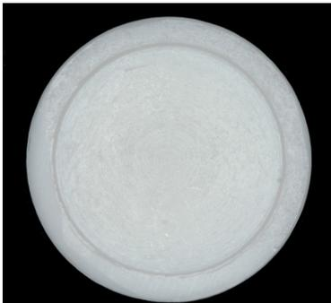
Figura 9: Dispositivo em teflon com depressão central com 1 mm de profundidade para padronização da espessura dos blocos de dentina.
