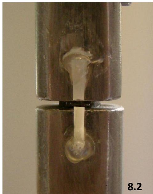
Figuras 8 – Ensaio de resistência à microtração: (8.1) Amostra submetida ao ensaio de resistência de união à microtração; e, (8.2) Amostra fraturada.
