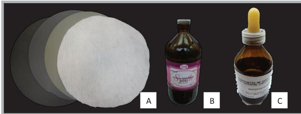
Figura 14 – A- Lixas de granulação 600-, 1200- e 2000- e feltro; B – Ácido fosfórico a 85%, utilizado sob diluição a 37%; C – Hipoclorito de sódio a 10%;
