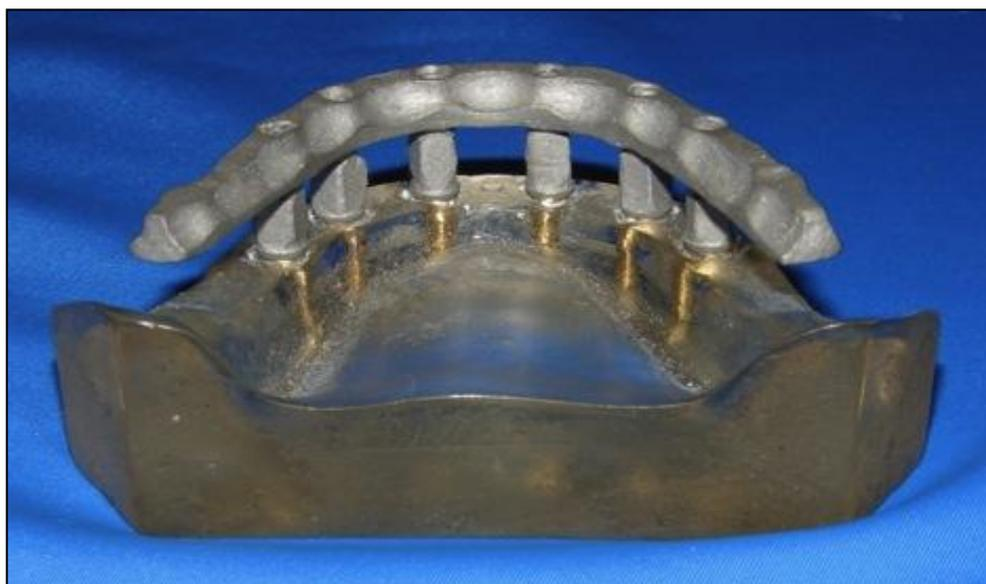
Figura 6 – Corpo-de-prova monobloco parafusado no modelo experimental
