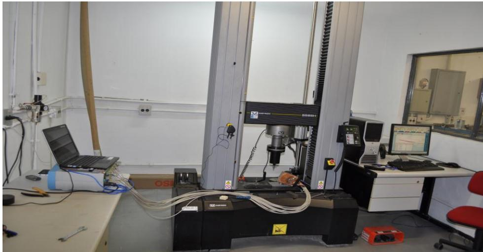
Figura 13 – Modelo experimental fixado Máquina de ensaios Instron 5585H.
