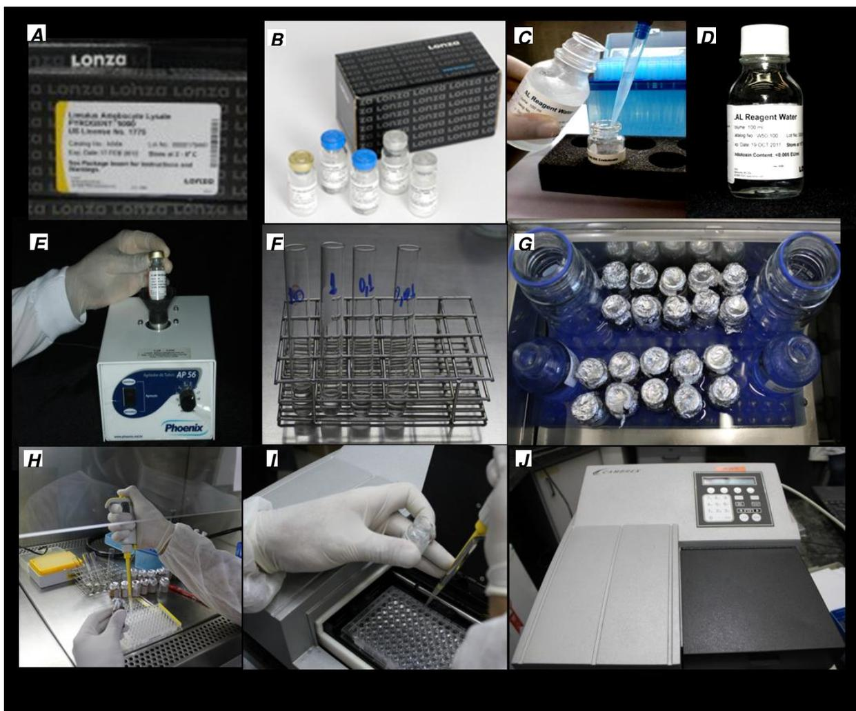
**Figura 6.** Ensaio cinético quantitativo para detecção de endotoxinas. **A, B** – Kit Pyrogen 5000; **C**– Reconstituição do Substrato de endotoxina; **D**- Água de LAL; **E**- Agitação mecânica em vórtex do substrato de endotoxina; **F**- Diluições seriadas para obtenção da curva padrão, **G**- Amostras em banho-maria; **H**- Preparo da placa; **I**- Inoculação do controle positivo (*Spike procedure*); **J**- Leitor Biotek.
