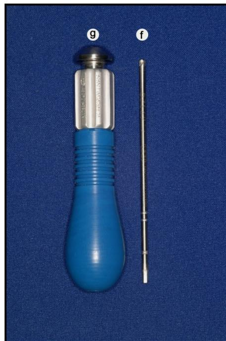
Figura 25 – (f) Chave *crossdrive* e (g) cabo para chave com engate rápido.
