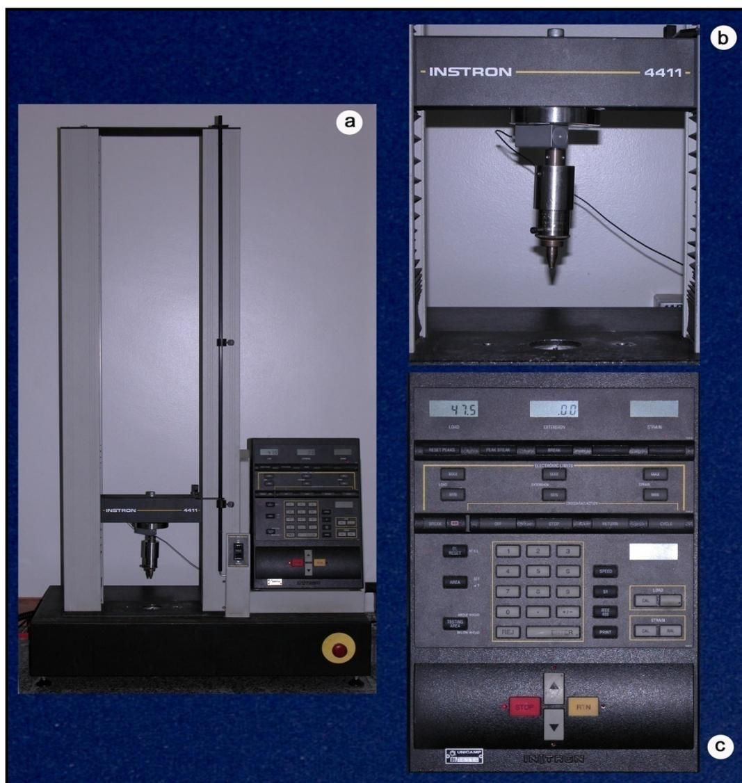
Figura 35 – Aparelho Instron 4411. (a) Vista geral. (b) Mesa de trabalho, com plataforma de deslocamento e célula de força de 50 kgf. (c) Central de controle do aparelho.
