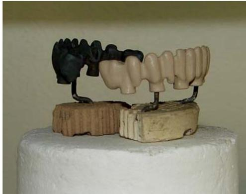
Figura 31 – Corpo de prova submetido apenas ao ciclo de cocção da cerâmica, juntamente com o corpo de prova com cerâmica como revestimento estético.
