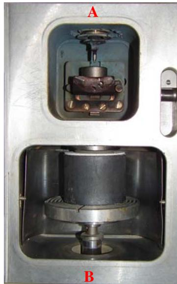
Figura 12 - Máquina de Fundição da infra-estrutura: A- Câmara superior com pastilha de Ti c.p. e B- Câmara inferior com molde de revestimento.
