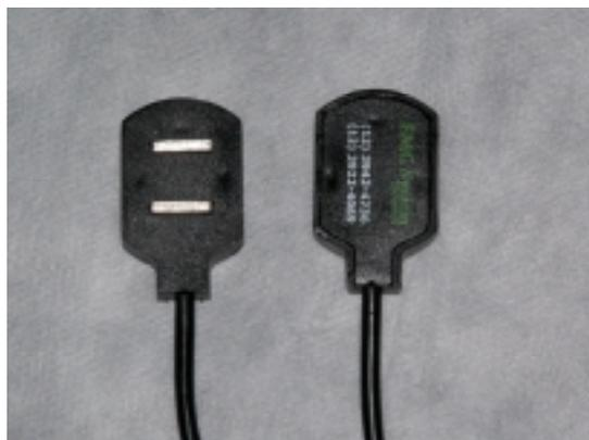
Figura 24 – Eletrodos ativos de superfície.
