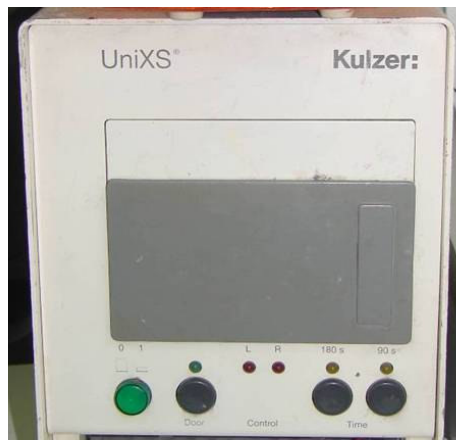
Figura 23: Polimerização final da resina fotopolimerizável no aparelho UniXS.
