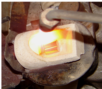
Figura 7: Aquecimento da liga Co-Cr no cadinho, para fundição por centrifuga e maçarico.
