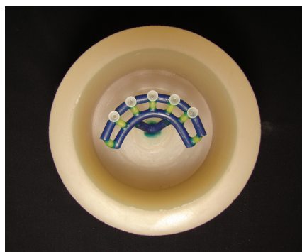
Figura 6: Enceramento posicionado no anel de silicone para fundição.
