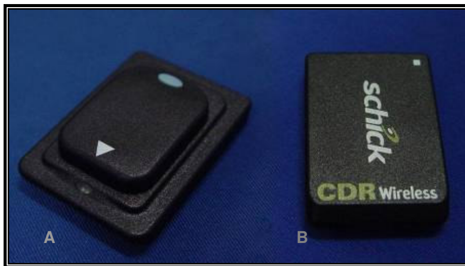
Figura 2 - Sensor do sistema CDR Wireless®. A- Face posterior (bateria); B- Face ativa anterior.
