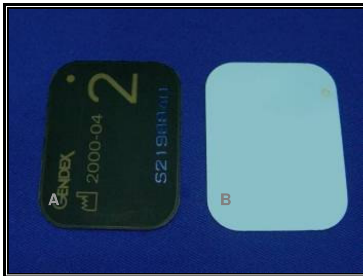
Figura 6 – Placa de fósforo do sistema DenOptix®: A - Face posterior da placa; B – Face ativa da placa.
