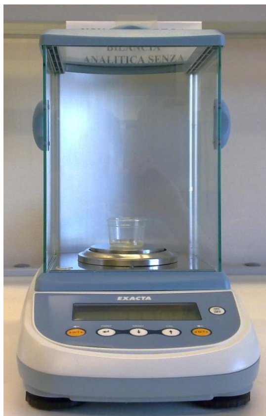
Fig. 1 – Balança utilizada para o proporcionamento dos reagentes.
