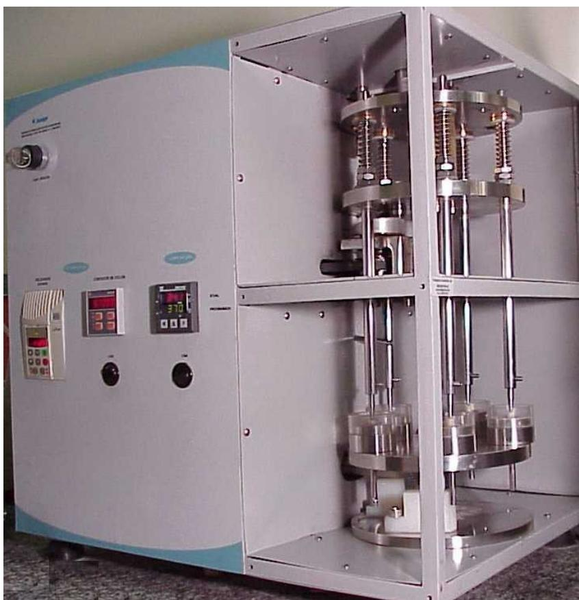
Figura 9 – Máquina de ensaio de fadiga
