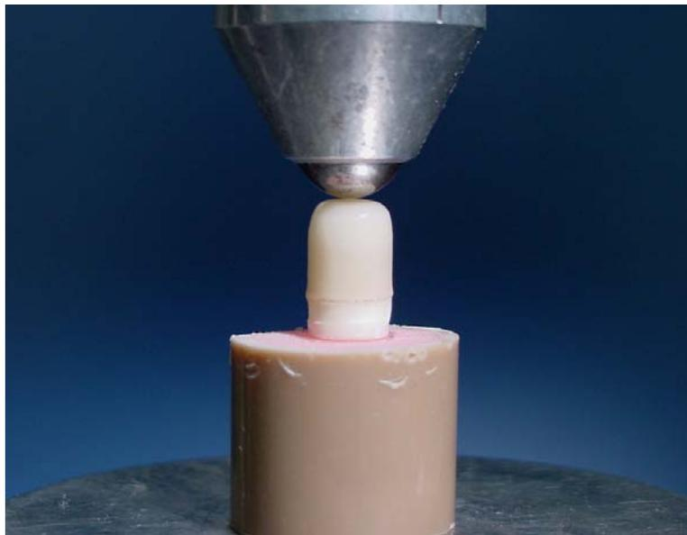
Figura 7 – Corpo-de-prova posicionado na Instron para ensaio de resistência à fratura
