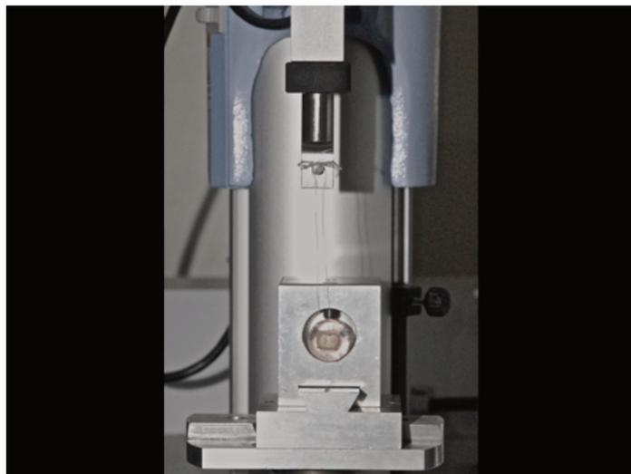
Figura 15:Corpo de prova posicionado na máquina de ensaio universal EZ Test- L.
