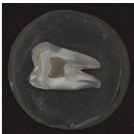
Figura 10 – Amostra preparada para análise da microdureza de esmalte e dentina.
