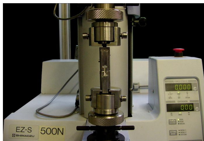
Figura 7 – Palito fixado com cola à base de cianoacrilato (Super Bonder, Henkel/Loctite) em dispositivo para microtração acoplado à máquina universal de ensaio (EZ Test, Shimadzu Corp.).
