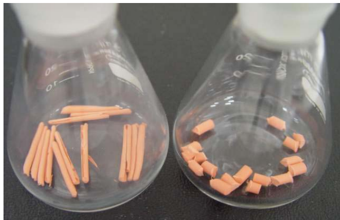
Figura 4 – Material obturador após pesagem, pronto para iniciar o processo de dissolução com uso de clorofórmio
