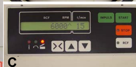
Figura 7 – Amostras dissolvidas em clorofórmio colocadas no interior de tubos de teflon (A) para a centrifugação (6000 rpm / 15 min) (B e C) e separação das porções orgânica e inorgânica das amostras. Esta separação ocorre por sedimentação.
