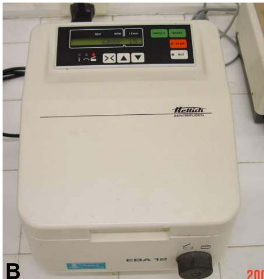
Figura 7 – Amostras dissolvidas em clorofórmio colocadas no interior de tubos de teflon (A) para a centrifugação (6000 rpm / 15 min) (B e C) e separação das porções orgânica e inorgânica das amostras. Esta separação ocorre por sedimentação.
