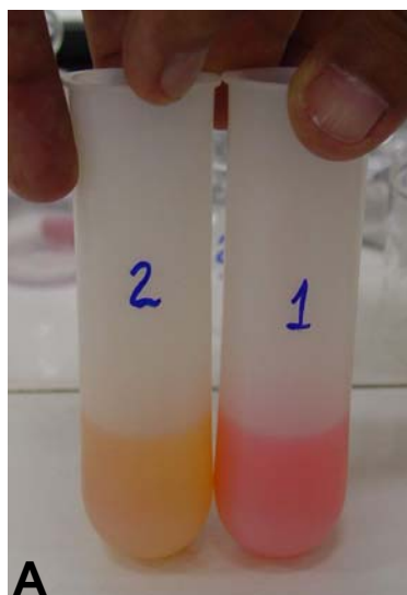
Figura 7 – Amostras dissolvidas em clorofórmio colocadas no interior de tubos de teflon (A) para a centrifugação (6000 rpm / 15 min) (B e C) e separação das porções orgânica e inorgânica das amostras. Esta separação ocorre por sedimentação.
