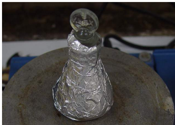
Figura 5 – Frasco sob agitação, envolvido com papel alumínio para proteção da luz ambiente, evitando foto-oxidação dos componentes.
