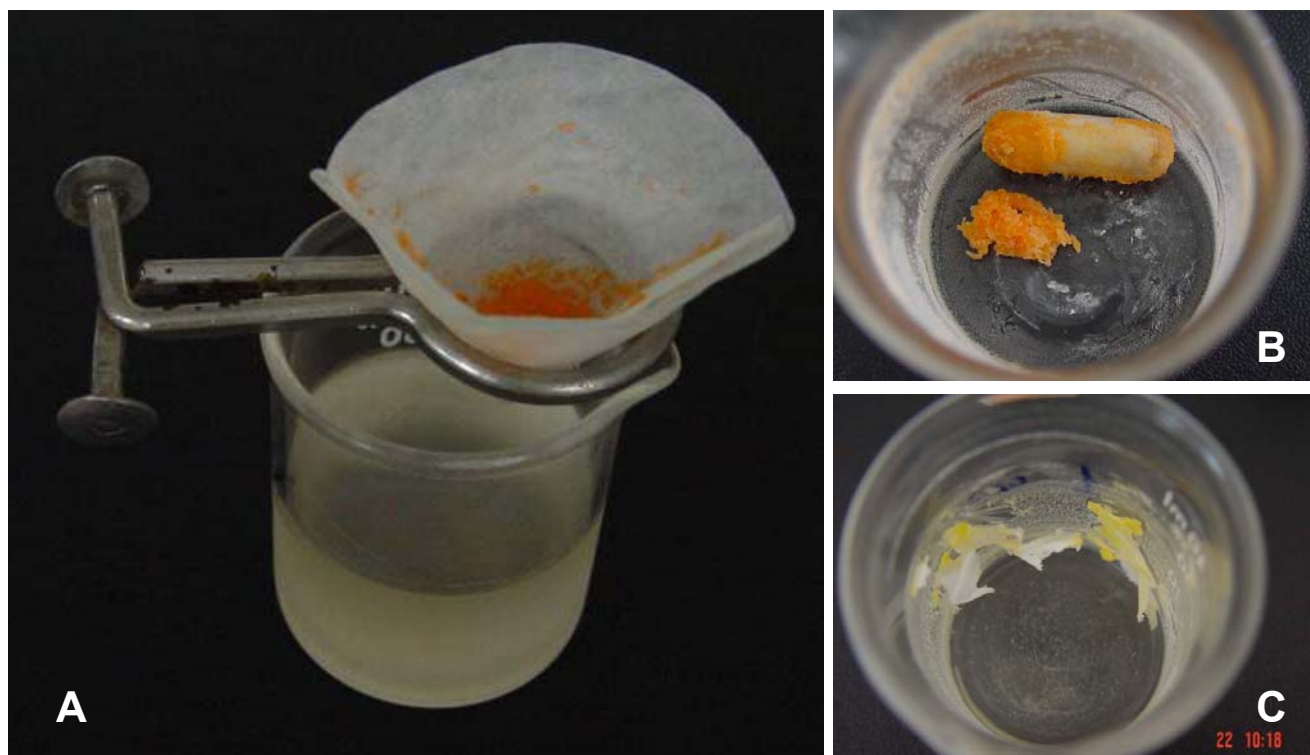
Figura 11 – Porção orgânica durante processo de filtragem (A) para separação dos componentes orgânicos guta-percha (filtro e frasco inicial) (B) e cera/resina (frasco após filtragem) (C).
