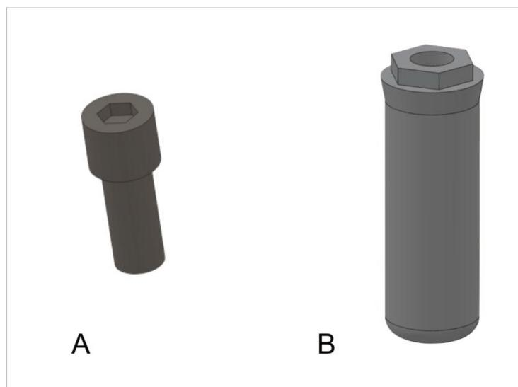
**Figura 3 – Parafuso de retenção da barra (A) e implante dentário (B) modelados.**
