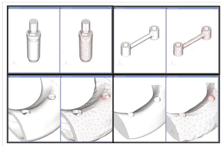
**Figura 5 – Malha do modelo criado com elementos finitos.**
