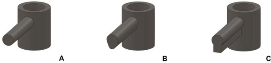
**Figura 4 – Formas da secção transversal da barra: circular (A), ovóide (B), e Hader (C).**
