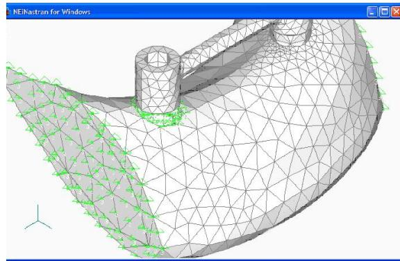
**Figura 6 – Restrições de movimentos aplicadas no modelo**
