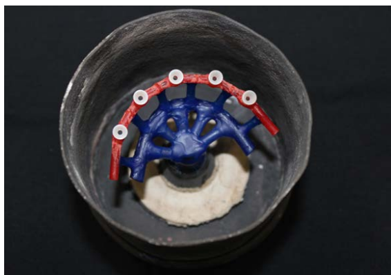
Figura 10 - Conjunto infraestrutura encerada e condutos de alimentação em anel metálico.
