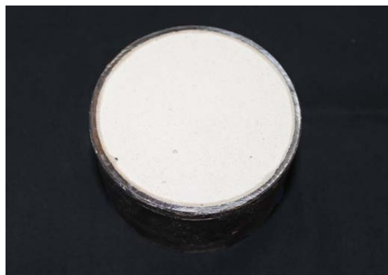
Figura 11 – Anel metálico após a inclusão do revestimento.
