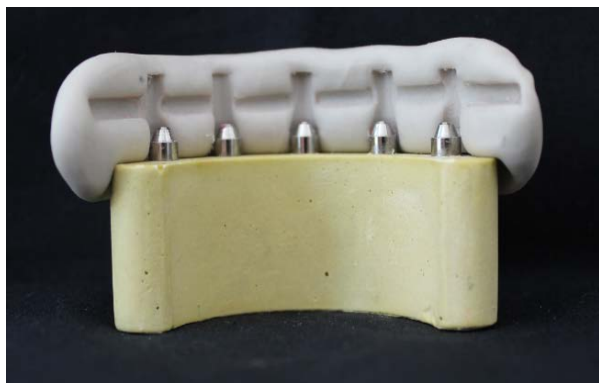
Figura 8 – Guia em silicone para padronização das peças.
