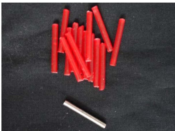
Figura 7 – Barras em resina acrílica obtidas a partir de barras pré-fabricadas de Titânio.
