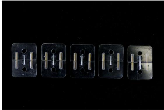
**Figura 26.** Microdispositivos em forma de matriz com os *palitos* fixados
