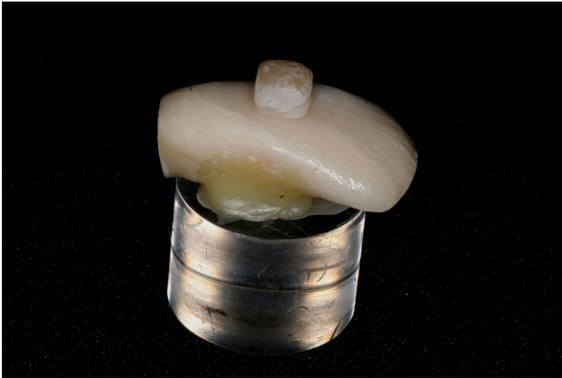
**Figura 19.** Conjunto dente restaurado/bloco de acrílico para o substrato esmalte
