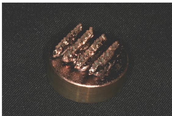
**Figura 30.** Palitos fraturados posicionados em stub metálico e metalizados com ouro
