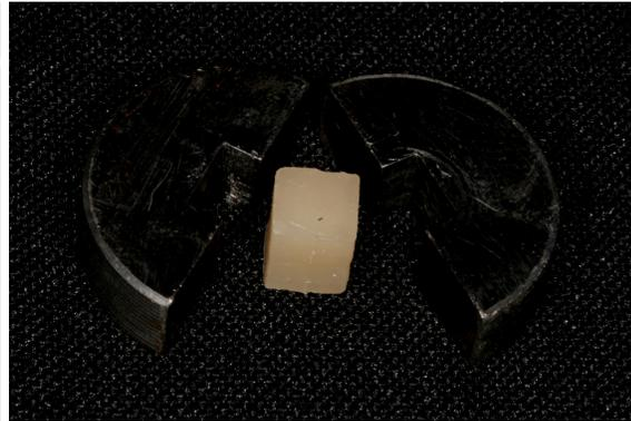
**Figura 16.** Bloco de resina composta de 6mm confeccionado em Z250 na cor A4
