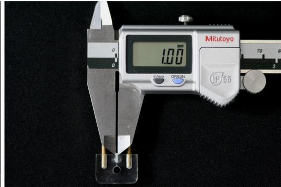
**Figura 28.** Mensuração com paquímetro digital dos lados do *palito* fraturado
