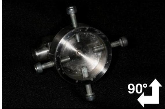
**Figura 22.** Dispositivo de corte que se movimenta em 90° e que recebeu os blocos de acrílico
