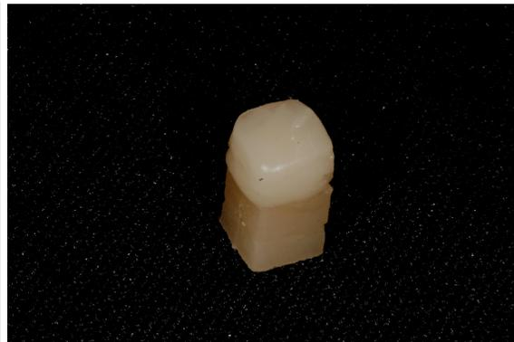
**Figura 18.** Bloco de resina composta restaurado com a resina Z250 na cor A2
