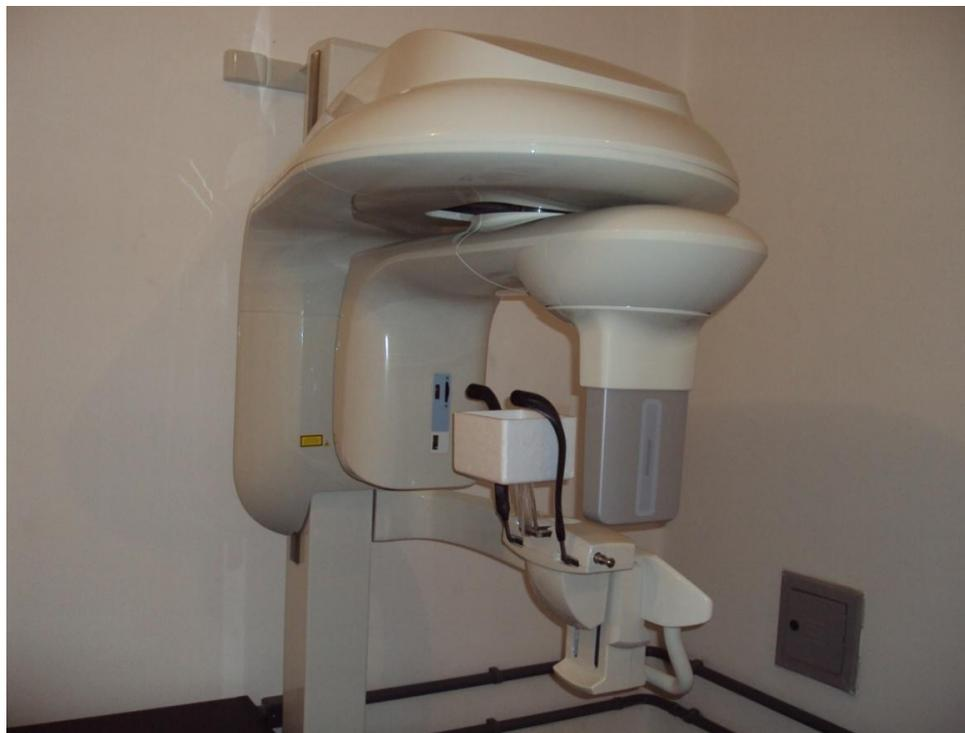
Figura 4 – Aparelho Kodak 9000 com phantom posicionado.
