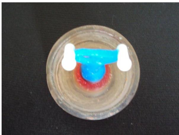
**Figura 5**– Padrões de cera posicionados na base formadora de cadinho.
