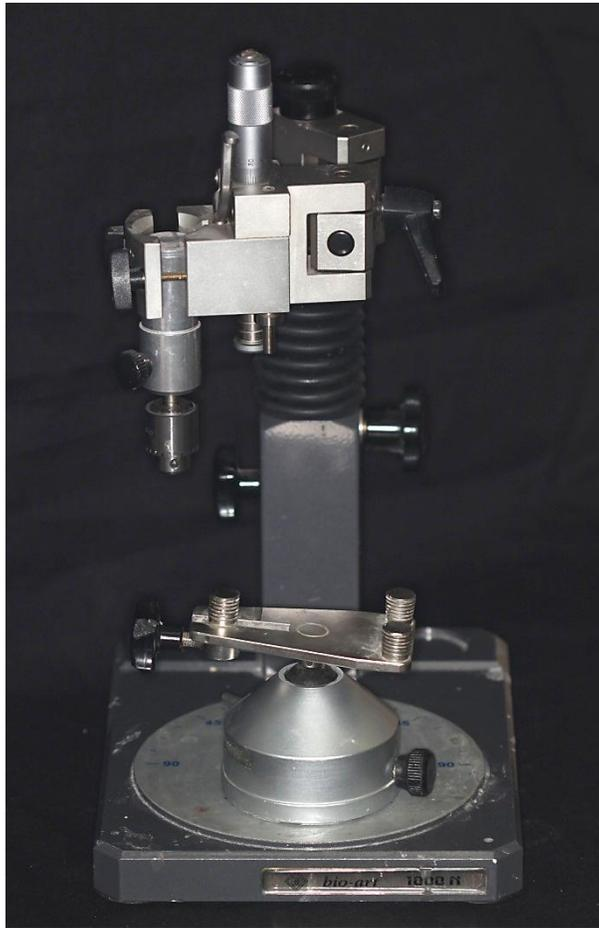
**Figura 1-** Delineador N1000 (Bio-art) empregado para confecção dos orifícios de fixação dos implantes nos troquéis de resina acrílica.
