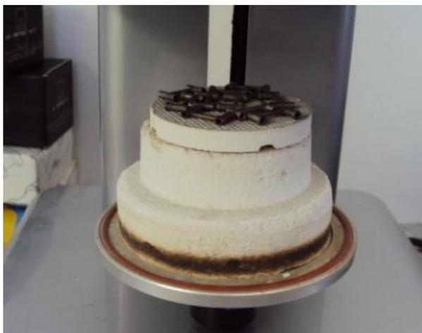
**Figura 9-** Corpos-de-prova posicionados sobre suporte refratário do forno de cocção para simulação dos ciclos de cocção da porcelana.
