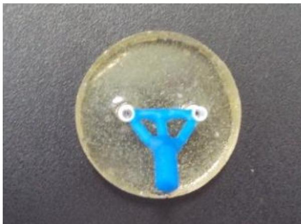
**Figura 3-** Padrão de fundição em cera. Notar presença de condutos de alimentação.
