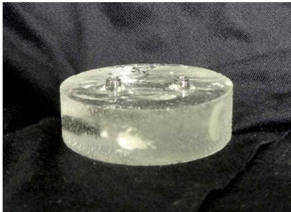
**Figura 2 –** Troquel cilíndrico em resina acrílica no qual foram inseridos os implantes.
