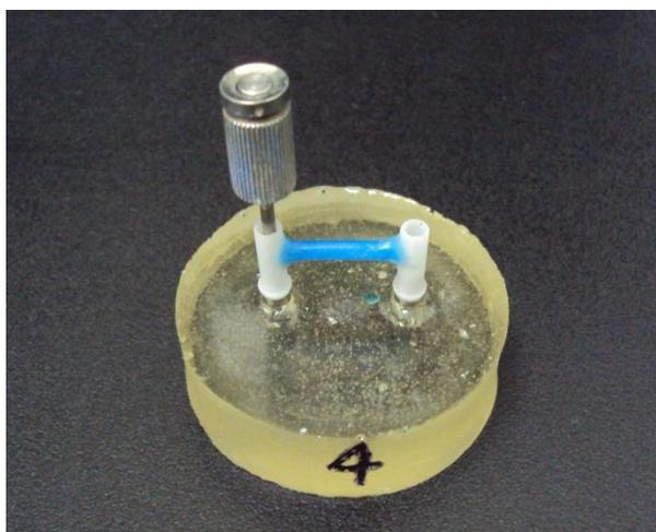
**Figura 4-** Teste de passividade do padrão em cera pela técnica do parafuso único.
