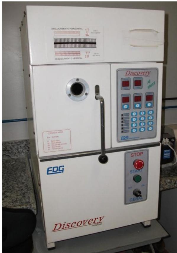
**Figura 7-** Máquina de fundição Discovery.
