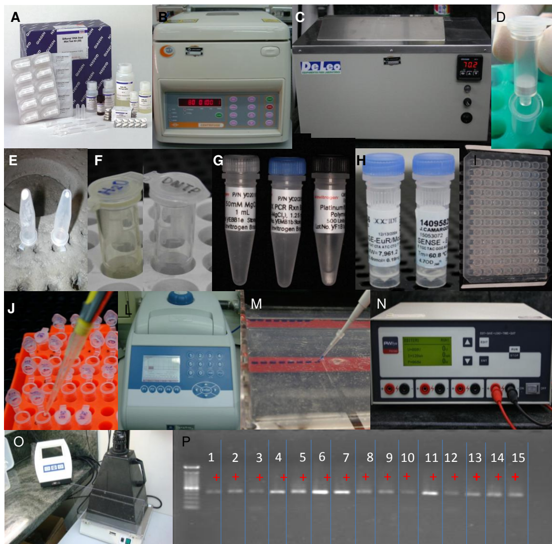
Figura 3. Isolamento do DNA bacteriano. A – QIAamp DNA kit (QIAGEN, Chatsworth, CA, EUA), B – Centrífuga, C – Amostras em banho d'água, D – Filtro contendo membrana de sílica para retenção do DNA, E – DNA isolado. Preparo da reação da PCR. F, G, H – Reagentes utilizados para o preparo do mix da PCR: água Milli-Q estéril, dNTPs, Cloreto de magnésio, buffer , Taq DNA polymerase , primers , I – Placa de 96 poços ou microtubos (J) com as amostras distribuídas para receber o mix , L – Termociclador. Visualização do produto da PCR. M – Inserção das amostras nos poços do gel de agarose, N – Fonte de eletroforese, O – Transiluminador de luz ultravioleta, P – Visualização das bandas em gel de agarose através da eletroforese utilizando primer universal.
