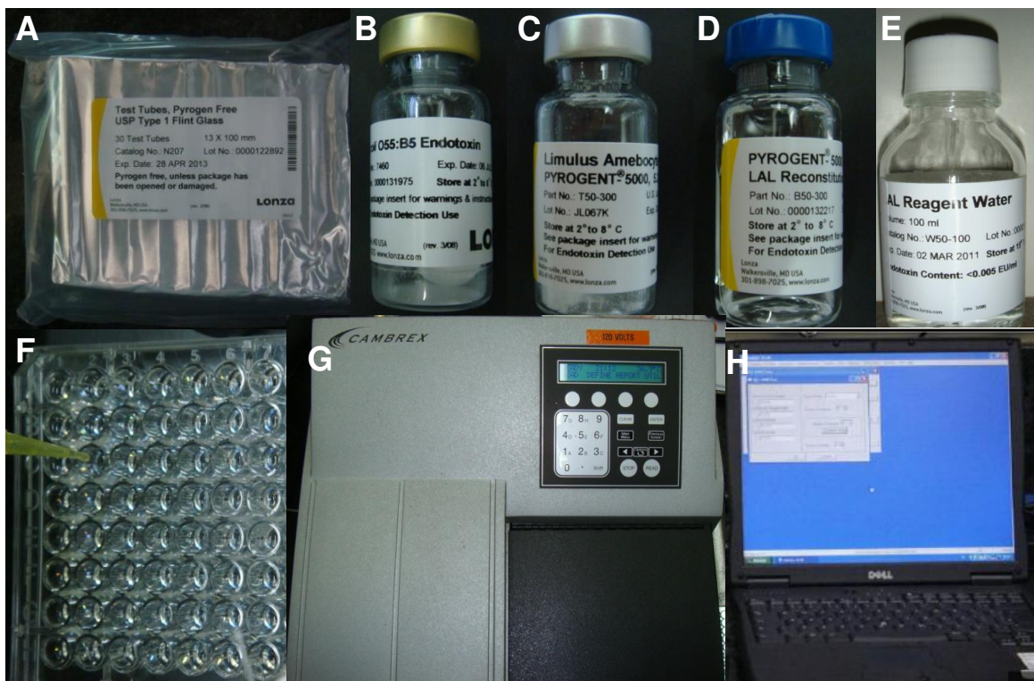
Figura 4. Teste LAL Pyrogen-5000: A – Tubos de ensaio apirrogênicos para preparo da curva padrão, B – Endotoxina E. coli 055:B5, C – Reagente Pyrogen-5000 LAL, D – Tampão de reconstituição Pyrogen-5000 LAL, E – Água LAL reagente, F – Distribuição do reagente Pyrogen-5000 LAL reconstituído na microplaca de 96 poços, G – Leitor Biotek (ELX 808, Winooski, VT, EUA), H – Software WinKQCL (Lonza, Walkersville, MD, EUA).
