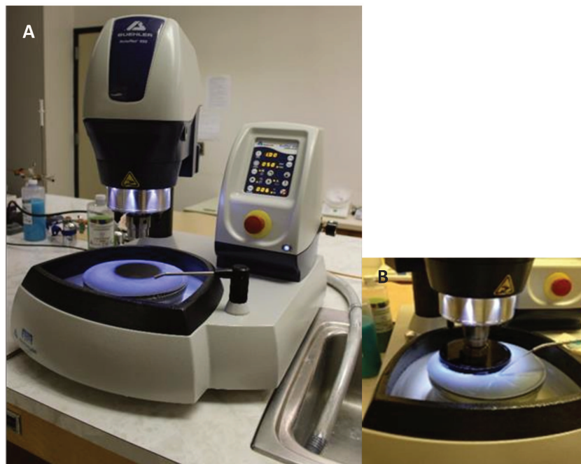
Figura 13 – A) Politriz AutoMet 250 (Buehler, EUA). B) Detalhe mostra espécimes durante processo de polimento.
