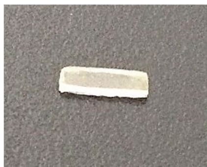
Figura 6 – Espécimes em forma de barra utilizados para os testes de módulo de elasticidade e resistência à flexão.
