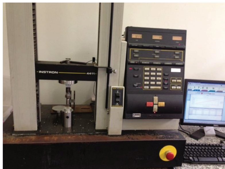
Figura 13 – Máquina Universal INSTRON, modelo 4111 (Instron Corp., EUA), utilizada para os testes de módulo de elasticidade/resistência à flexão.
