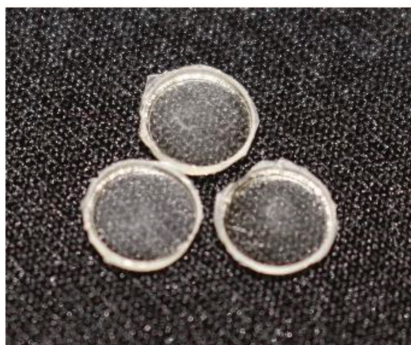
Figura 5 – Espécimes cilíndricos utilizados para os testes de sorção/solubilidade e densidade de ligações cruzadas.
