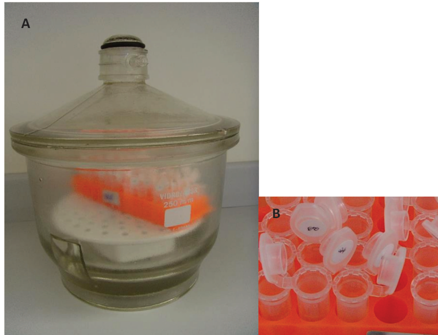
Figura 7 – A) Teste de sorção/solubilidade - espécimes em processo de secagem por meio de dessecador à vácuo com sílica gel armazenados separadamente em Eppendorfs. B) Detalhe mostrando Eppendorfs abertos).
