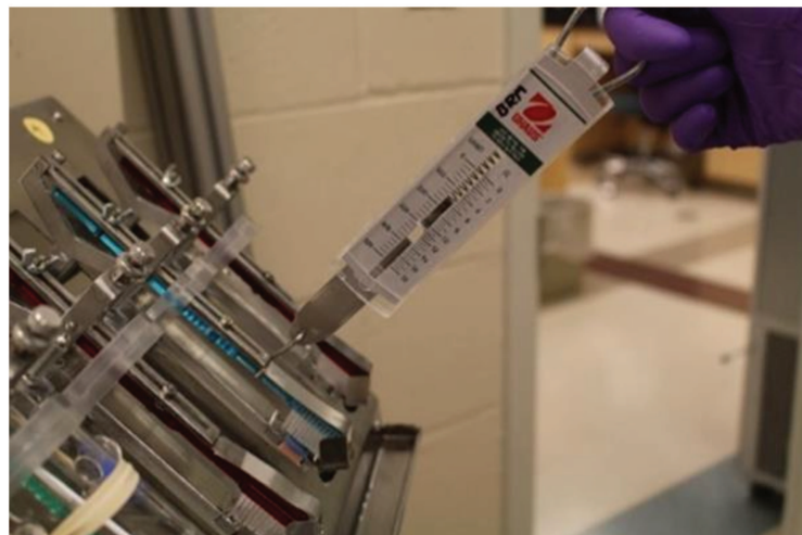
Figura 19 – Padronização de força para escovação por meio de dinamômetro.
