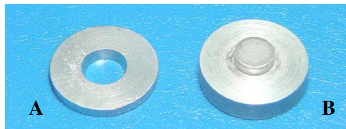
Figura 3 – (A) Matriz metálica expulsiva; (B) - Base
