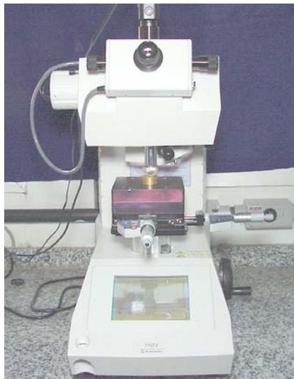
Figura 13 – Microdurômetro HMV-2 (Shimadzu).
