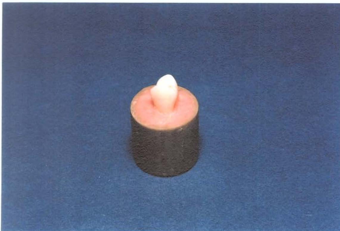
FIGURA 1- Pré-molar incluído em tubo de PVC, com resina acrílica.
