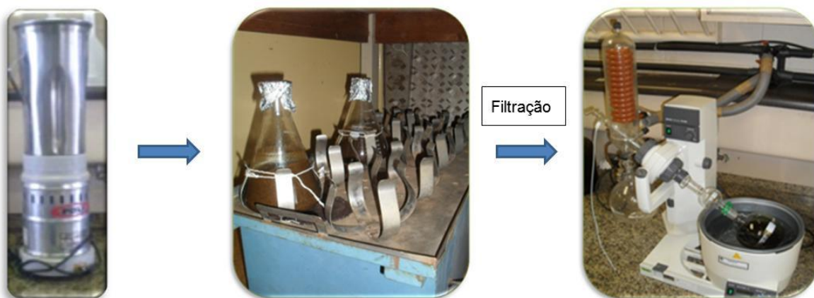
Figura 9 - Foto ilustrativa dos equipamentos e vidrarias utilizados durante o processo extrativo: (A) Liquidificador industrial Poli LS-06; (B) Agitador oscilatório e (C) Rotaevaporador Buchi RE 215.
