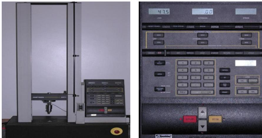
Figura 9: Máquina de ensaio universal e painel de controle da máquina
