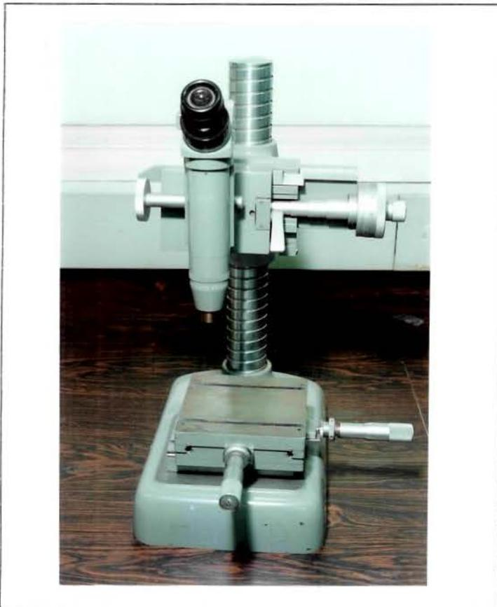
Figura 6.8 - Microscópio comparador (CARL ZEISS)
