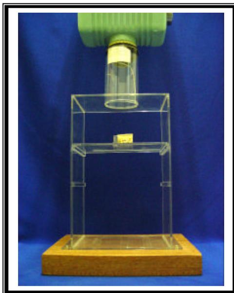
Figura 2 - Suporte de acrílico utilizado para padronizar as exposições.
