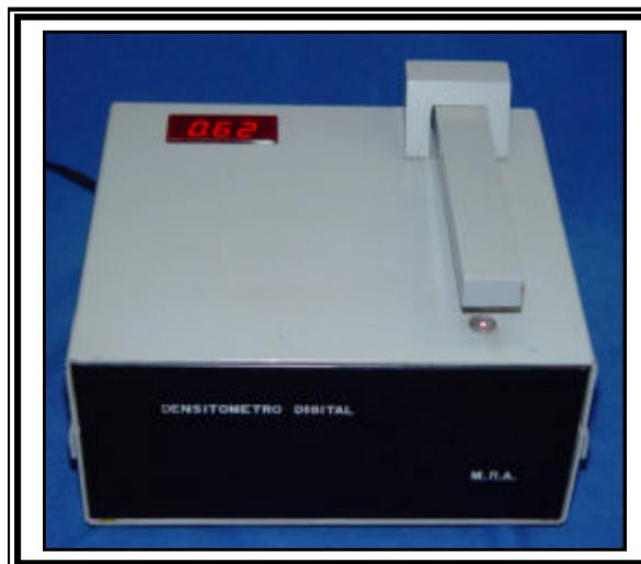
Figura 8 - Aparelho fotodensitômetro digital.
