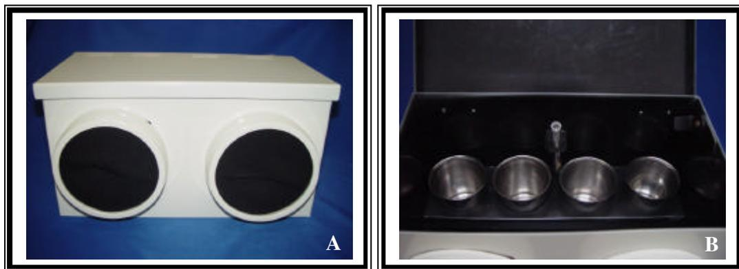
Figura 6: Câmara escura portátil utilizada no processamento das radiografias: visão externa (A) e interna (B), onde observam-se os quatro recipientes de aço inox.
