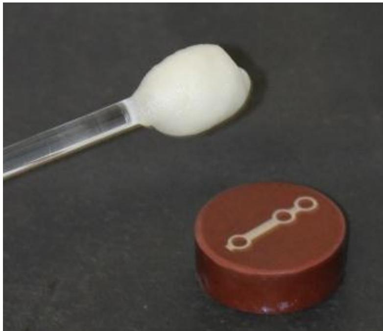
Figura 6: Corpo de prova sendo atacado com reagente ácido de Kroll. A solução permanece em contato com a superfície da peça por cerca de 30 segundos, sendo depois, lavada com água corrente.
