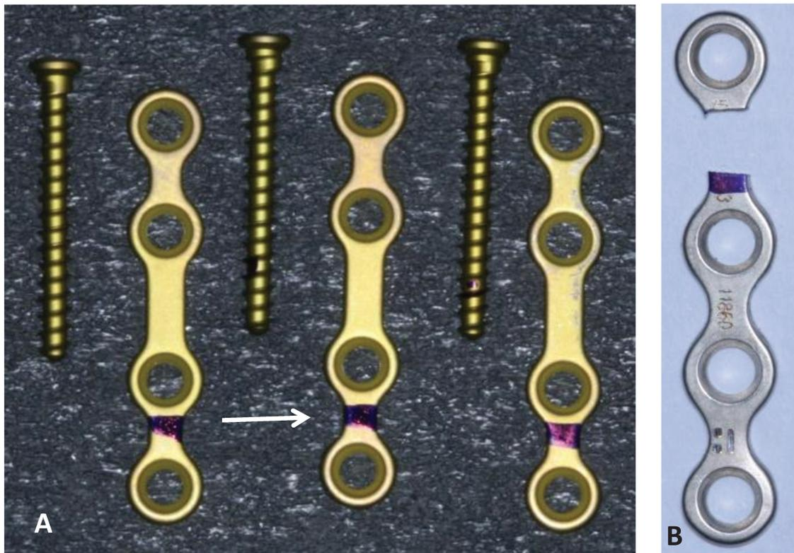
Figura 2: (A) Disposição de amostra de placas e parafusos do grupo I (Leibinger) com marcação na região onde será realizado o corte do segmento (seta). (B) Placa do grupo II (Tóride) já seccionada com segmento de placa inferiormente, utilizado nos testes metalográfico e de dureza, e segmento de elo superiormente, utilizado para teste de composição de gases.
