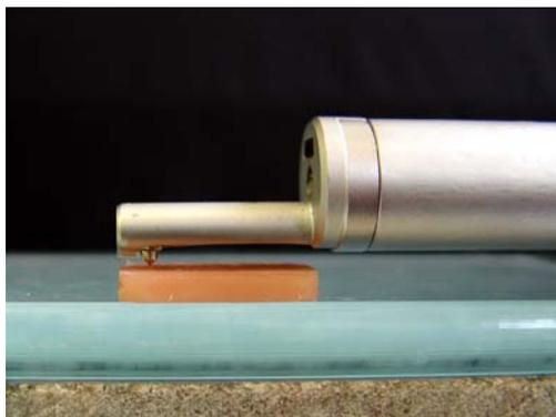
Figura 15 - Ensaio de Rugosidade Superficial.
