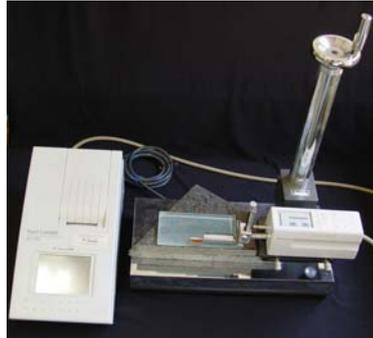
Figura 14 - Rugosímetro Surfscorder SE 1700
