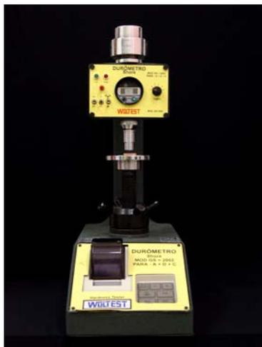
Figura 16 - Durômetro Shore A.
