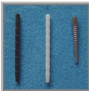
Figura 10 – Pinos pré-fabricados de fibra de carbono, fibra de vidro e metálico utilizados.
