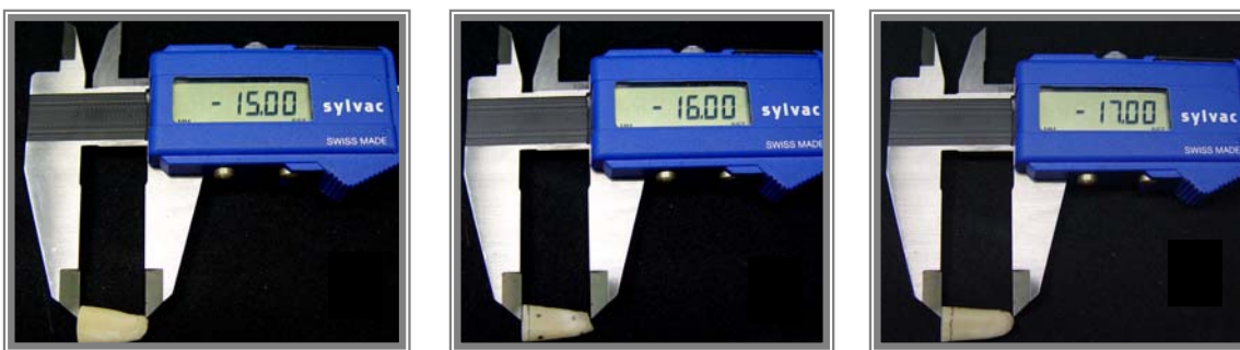
Figura 2 – Raiz com 15 mm de comprimento ( A ). Raiz com 16 mm de comprimento ( B ). Raiz com 17 mm de comprimento ( C ). Medidas obtidas por meio de paquímetro digital.
