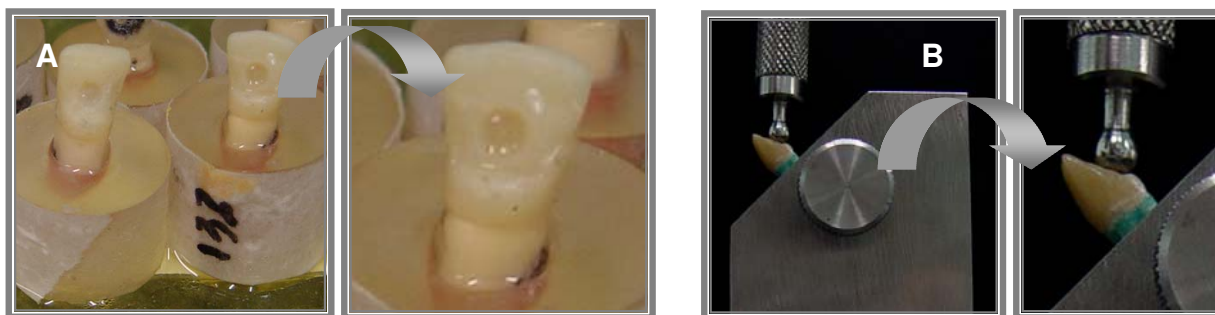
Figura 16 – Vista palatina das coroas com os nichos confeccionados ( A ). Corpo-de-prova adaptado ao dispositivo em máquina de ensaio universal ( B ).
