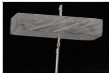
Figura 2b: Realização do orifício no centro da placa
