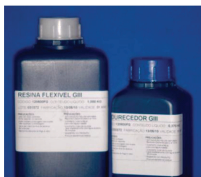
Figura 11 – Resina fotoelástica flexível (base e endurecedor).
