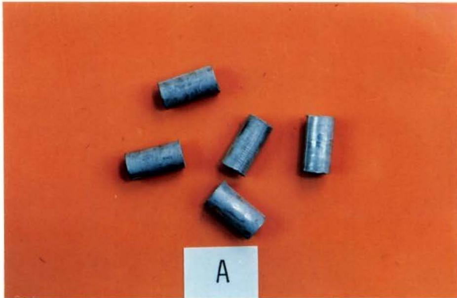
FIG. 4 - Corpos de prova - Aristalloy 21.
