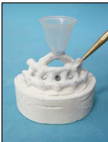
Figura 8- Camada de revestimento depositada sobre o padrão.
