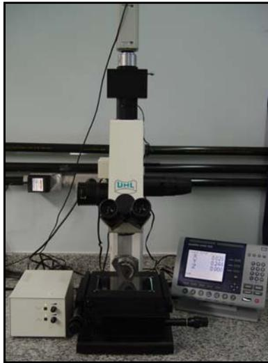
Figura 15- Microscópio acoplado ao sistema de medição Quadra – Chek 200.
