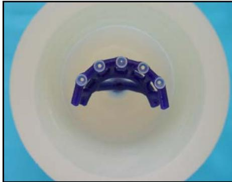
Figura 10- Padrão em cera para os grupos 2 e 3 na base formadora de cadinho do anel de inclusão.
