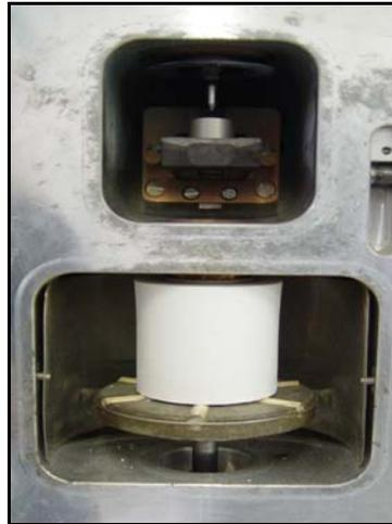
Figura 11- Pastilha e bloco de revestimento dispostos na máquina de fundição.
