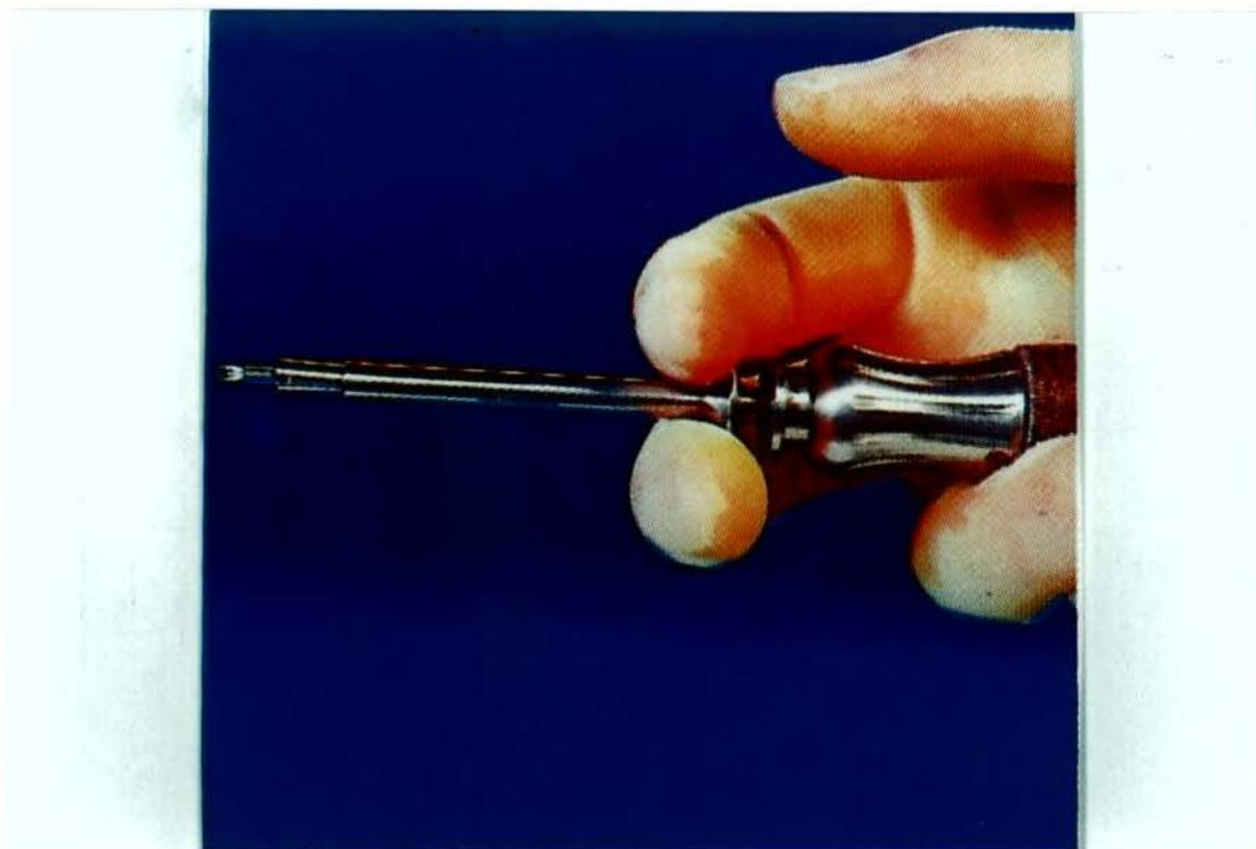
Figura 44. - Chave de apreensão e de aperto dos parafusos.
