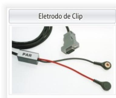
Figura 34: Pré-amplificador com ganho de 20 vezes da EMG System do Brasil Ltda.
