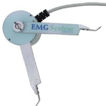
Figura 37: Goniômetro mandibular para mensuração da amplitude de abertura
