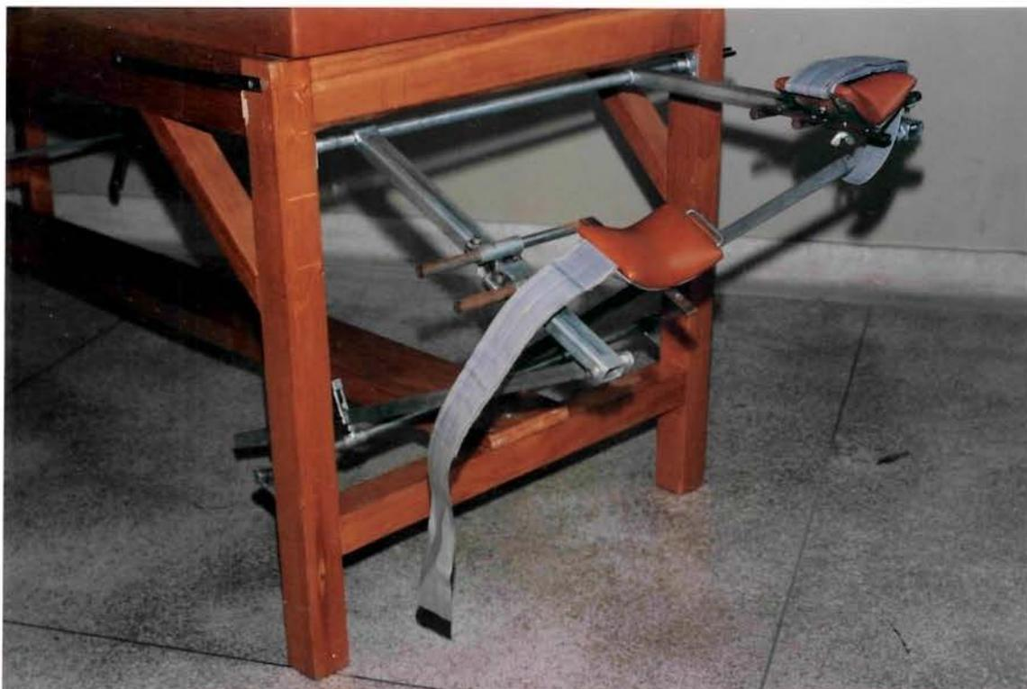
Figura 5 - Haste metálica que regula o ângulo de flexão da articulação do joelho(\*), e dispositivo côncavo almofadado para apoio da região do tendão calcâneo com fita de velcro (\*\*).
