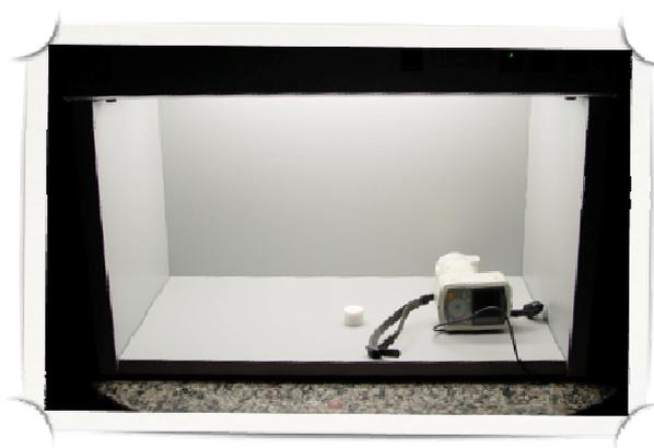
Figura 11 - Cabine de luz com espectrofotômetro e porta-amostra, onde foram realizadas as mensurações.
