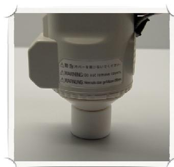
Figura 12 - Acoplamento do espectrofotômetro no porta-amostra.
