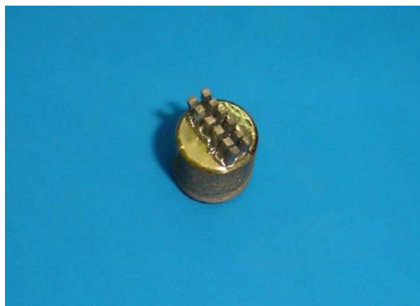
Fig. 9 – Espécimes fraturados montados em “stub” para análise do padrão de fratura.
