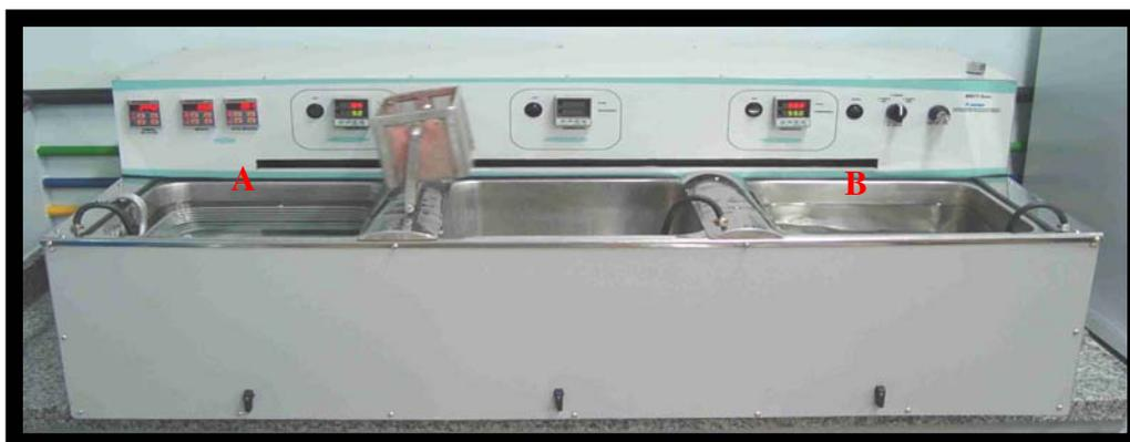
Figura 8 - Máquina de termociclagem: A -cuba de água fria e B –cuba de água quente
