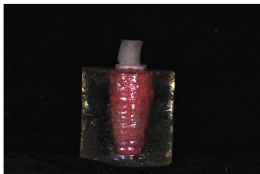
*Fig 19. Raíz inclusa em bloco de resina de poliestireno preenchida com Impregum F para simular ligamento periododntal*
