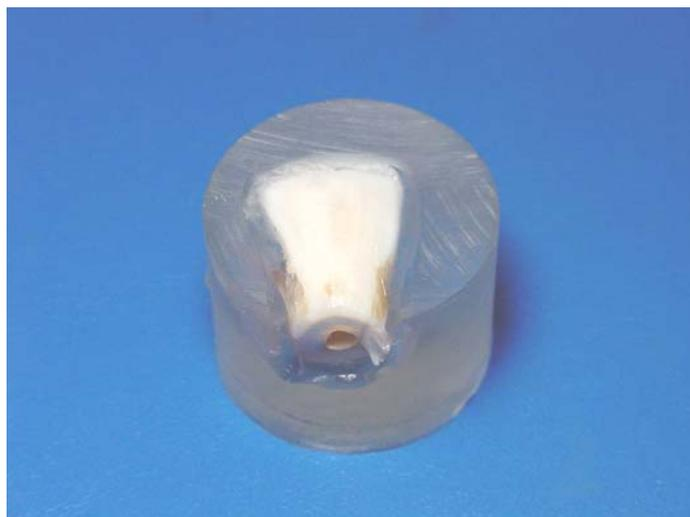
Figura 2 – Dente parcialmente embutido, com a face vestibular e a seção do canal radicular expostas.
