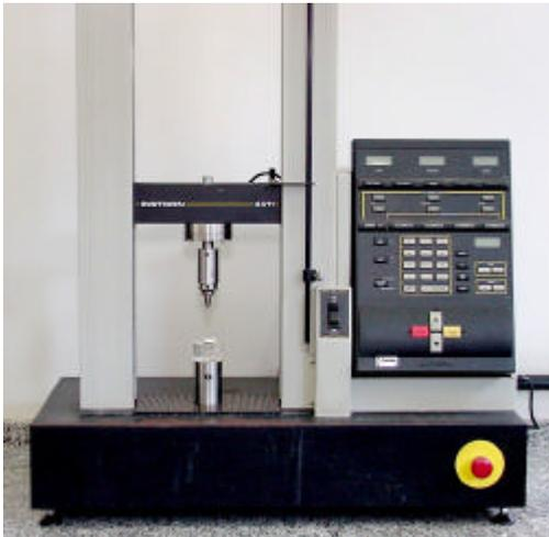
**Figura 20** – Máquina de ensaio universal Instron 4411.
