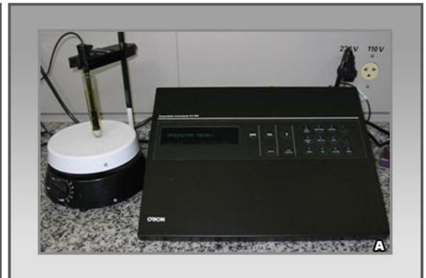
**Figura 2.A** Analisador de íons acoplado com Eletrodo íon-seletivo Orion 96-09.
