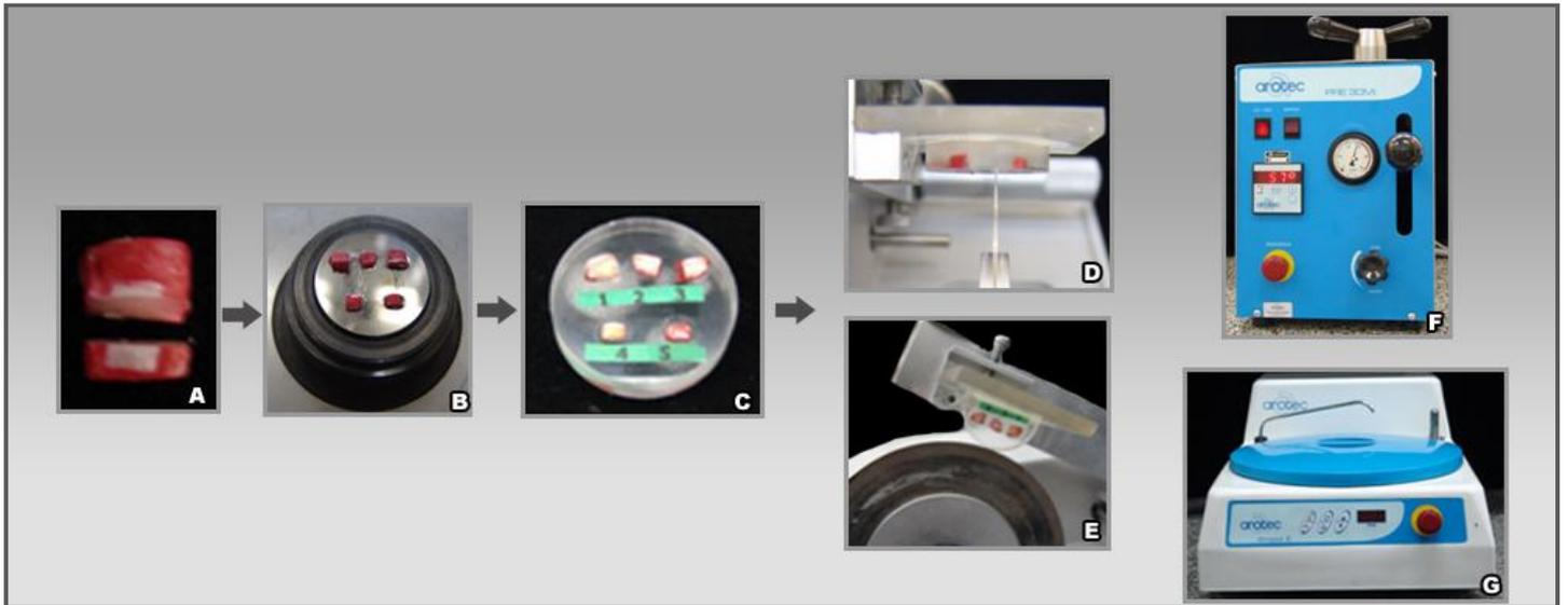
**Figura 1.** **A.** Espécime após o corte da área delimitada; **B.** Espécimes posicionados na embutidora; **C.** Aspecto final após os espécimes serem embutidos em resina acrílica; **D.** e **E.** Corte dos espécimes embutidos em fatias para análise de luz polarizada; **F.** Embutidora Arotec; **G.** Politriz Arotec.
