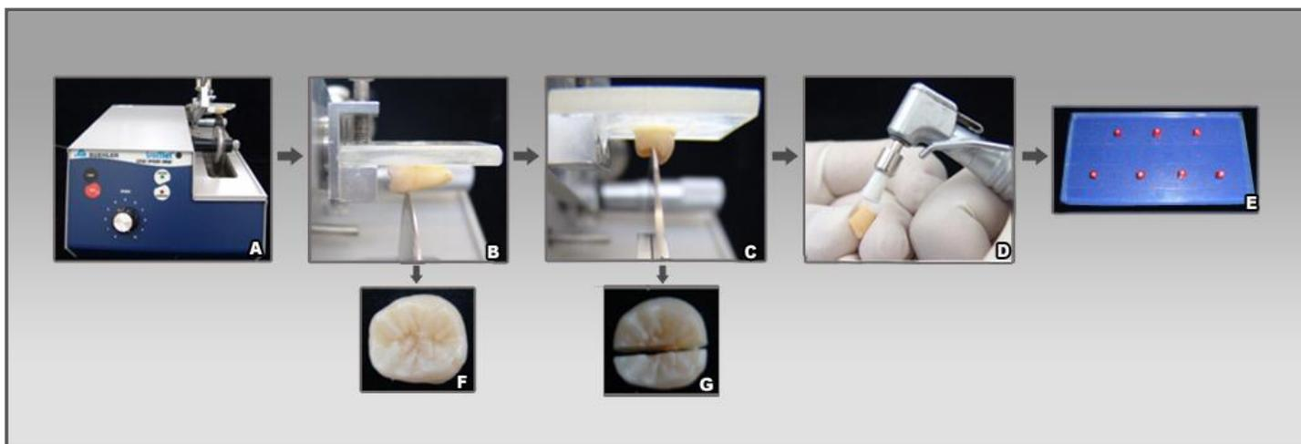
**Figura 2.** Preparo dos espécimes; **A.** Cortadeira Isomet. Buehler. Lake Bluff. Ill.. USA; **B e F.** Corte e remoção da porção radicular; **C e G.** Secção longitudinal da coroa no sentido méso distal; **D.** Profilaxia do espécime; **E.** Delimitação da área exposta para ser submetida aos testes.
