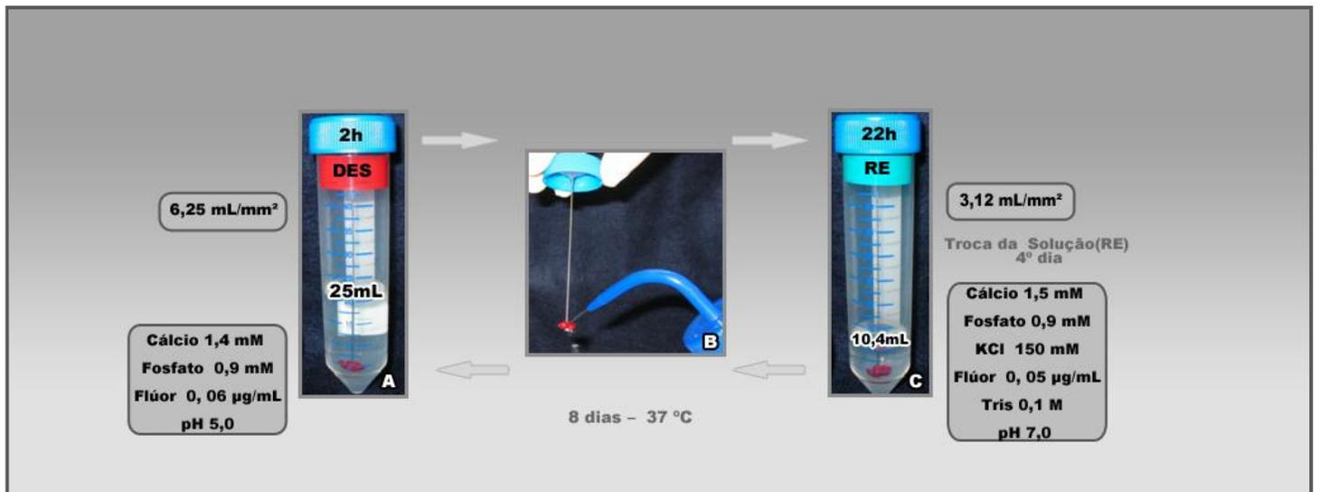
**Figura 2.** Esquema ilustrativo de ciclagem de pH; A. Tubo de ciclagem com solução desmineralizadora; B. Lavagem com água deionizada na troca de soluções na ciclagem; C. Tubo de ciclagem com solução remineralizadora.
