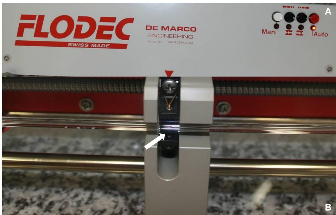
Figura 4 - Leitura da filtração de fluidos. A - Sistema FLODEC. B - Identificação automática da posição da bolha pelo FLODEC através da localização do menisco (seta).
