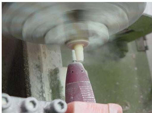
Figura 3 - Confeção da coroa no torno mecânico
