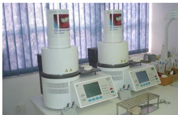
Figura 9 – Fornos elétricos EP 600 COMBI para IPS Empress
