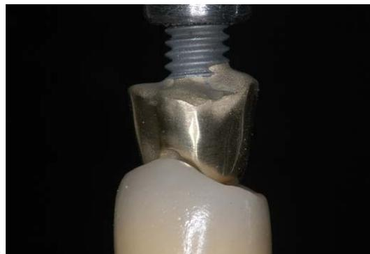
Figura 24- a) Corpo-de-prova e ponta ativa na haste metálica, após fundição; b) vista aproximada da ponta ativa acoplada na haste por meio do parafuso e c) contato oclusal da fundição metálica.
